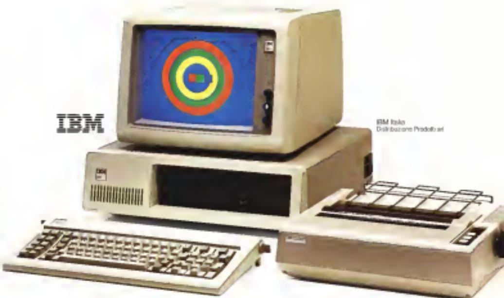
Il Personal Computer IBM contiene un microprocessore a 16 bit e una memoria di utilizzo che raggiunge 1640 Kbyte, e può essere dotato di un video a colori e di un co-processore matematico. E, grazie ai dischi fissi, la capacità massima di memoria del sistema è di 21 Mbyte in linea. Inoltre, puoi facilmente collegarti con un altro Personal Computer IBM, con elaboratori più potenti e con la rete dei Centri Servizi Elaborazione Dati della IBM.
